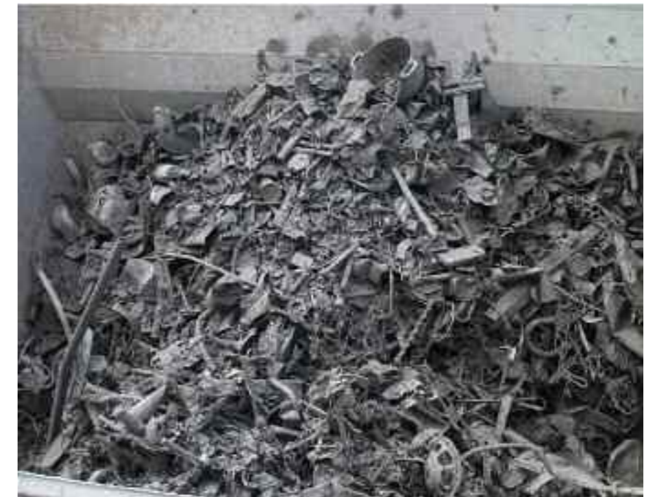
Metall skilt ut på overbåndsmagnet 0–200 mm før vibrasjonssikt.
