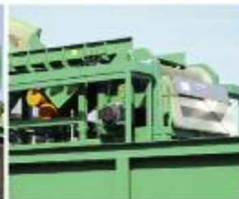
Virvelstrømsseparator VS1500 Separering av alu, koppar, zink
