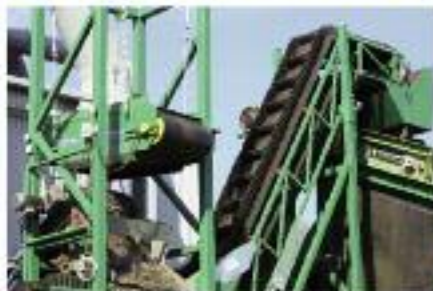
Magnetseparator MS1000S1400 Separering av jern
