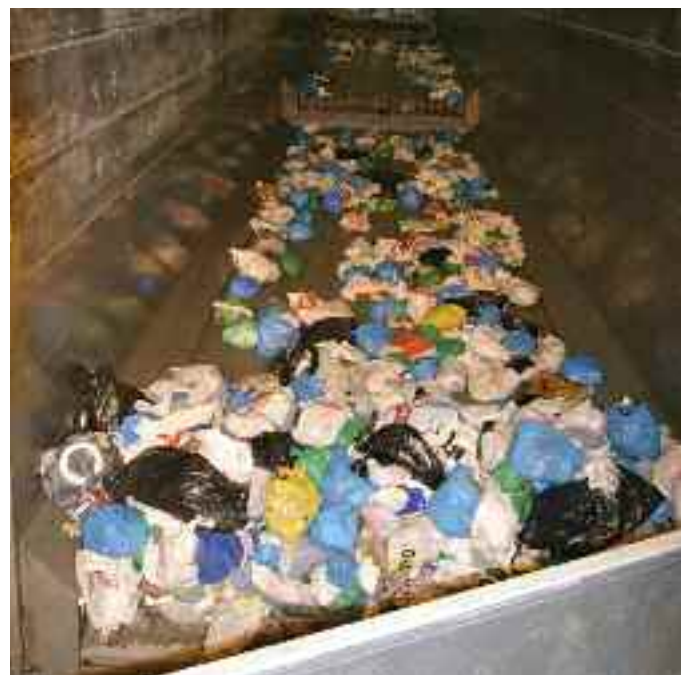
Avfall på vei inn i anlegget. Ved normal drift skal det kunne ta imot 30 tonn i timen, og på maksimal drift 45 tonn i timen.
