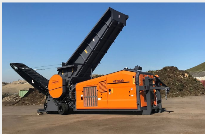
METHOR: Nyutviklet kvernkonsept med Dopp-Lock-system for raskt verktøyskifte.
